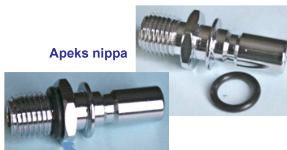
O-rengas tulee uraan kierteiden jälkeen
